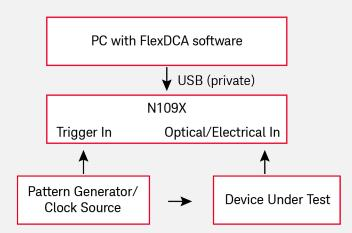
Figure 2. N1090X Test Setup
